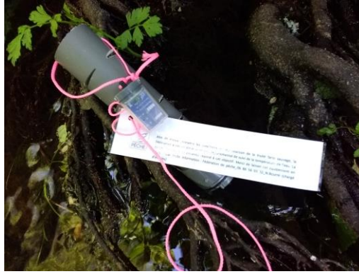
Photo n°11 : sonde thermique HOBO
